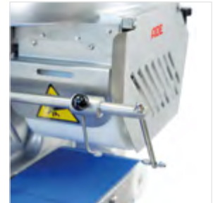
Abstreifer zur Reinigung der Formtrommel während des Betriebs
