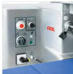
Das Förderband lässt sich anhand des Geschwindigkeitsreglers in der Schnelligkeit anpassen
