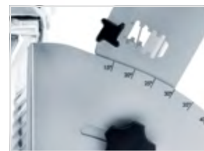
Schlittenneigung für unterschiedliche Scheibengrößen
